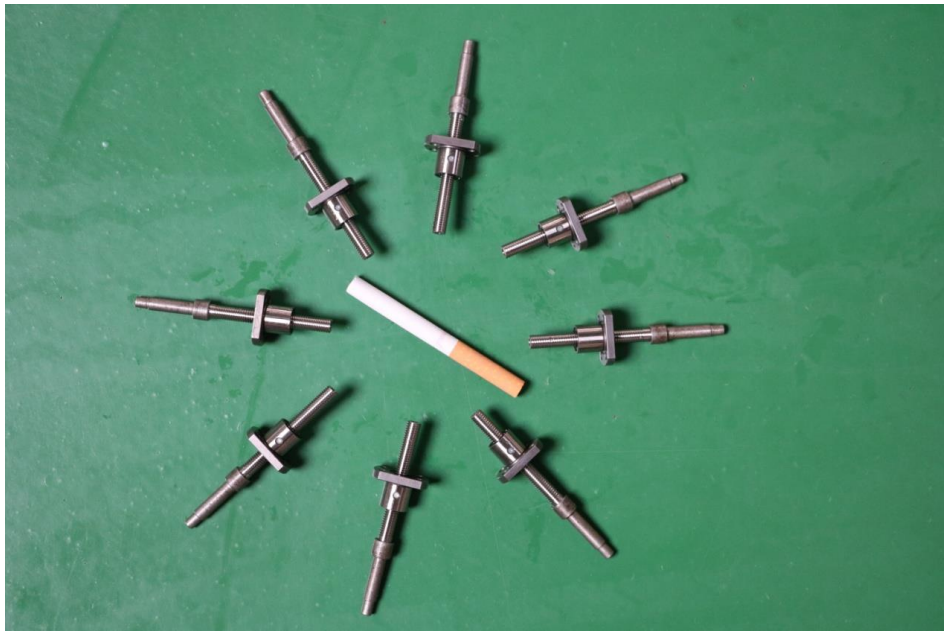
图 5-2 高耐磨防腐微型丝杠副
